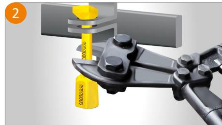
2 Перекусите стержень специальным инструментом, например, болторезом.
