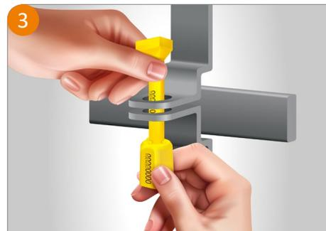
3 Защелкнуть замок на стержне до упора. Проверить надёжность фиксации.
